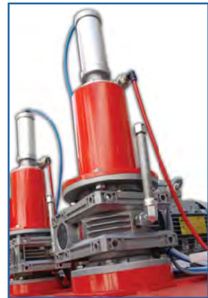
Pressione pneumatica delle spazzole Pression pneumatique brosses Pneumatic pressure of brushes Presion neumatica cepillo
