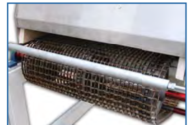
Nastro trasportatore in acciaio inox Tapis transporteur en acier Inox Inox steel belt conveyor Cinta transportadora en acero inox
